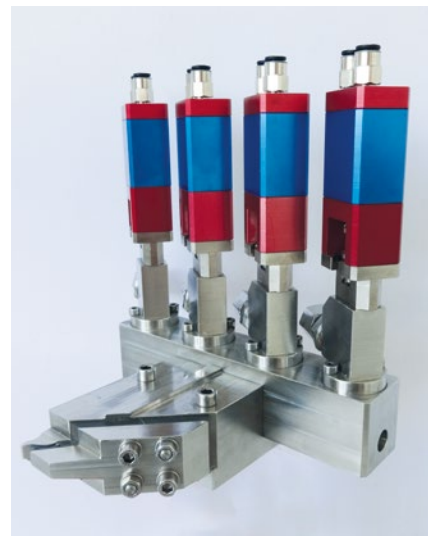
Auftragskopf COMBITAC S für Stegbeimungen
