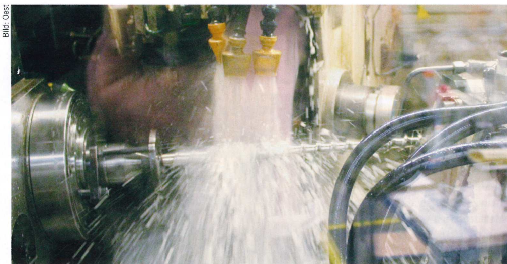
Auch Rotationsteile, wie zum Beispiel Schnecken, werden bei Arburg mit einem vollsynthetischen Kühlschmierstoff aus der Colometa-Familie hergestellt.
